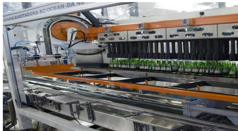
**Figura 5 - Desencaixotadora de garrafas**
