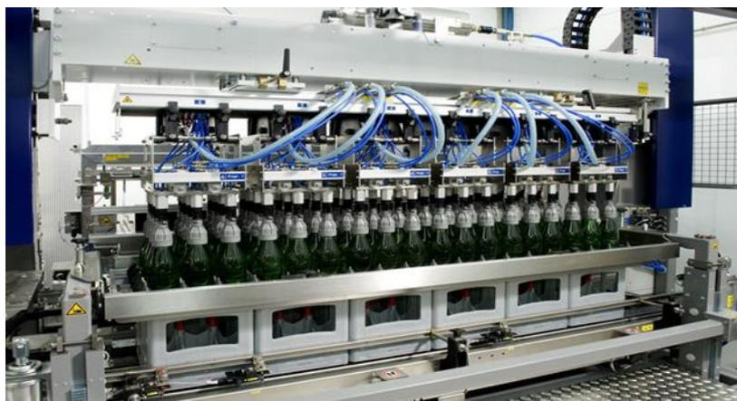
**Figura 11 - Encaixotadora de garrafas**
