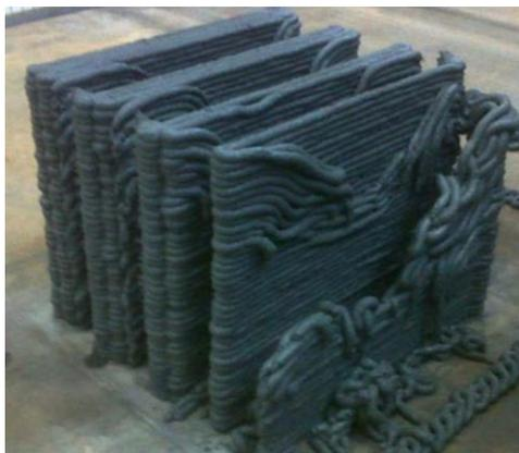
*Figura 10 - Camadas impressas colapsadas por seu próprio peso (Le, et al., 2011)*
