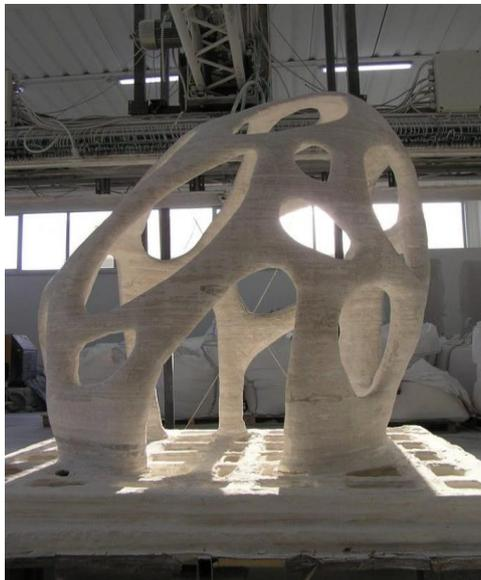
*Figura 7 - Radiolaria, a primeira escultura impressa em 3D de grande formato e geometricamente complexa, projetada por Andrea Morganti. Fonte: SHER (2019)*
