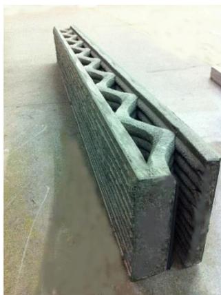
Figura 1 - Parede impressa. Fonte: CONTOUR CRAFTING (2016)
