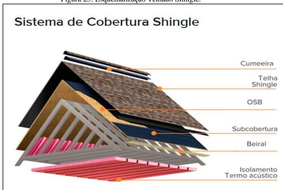
Figura 23: Esquematização Telhado Shingle.
