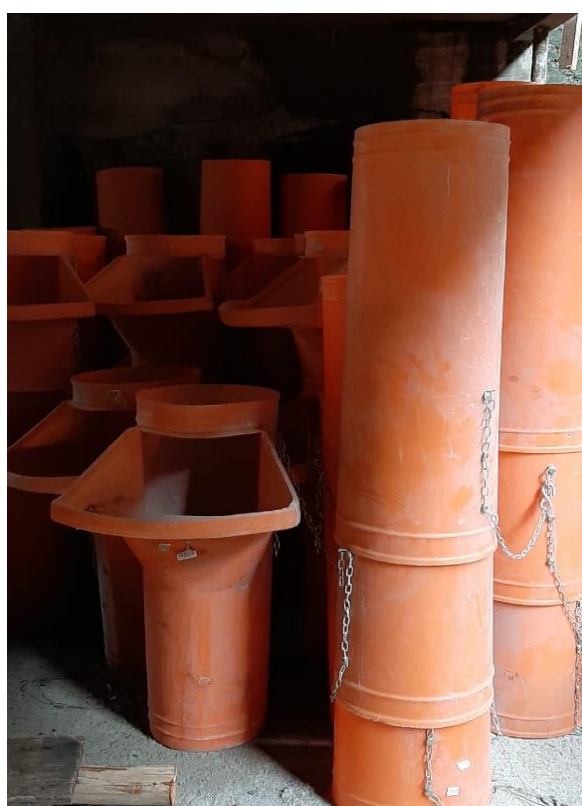
Figura 11 – Tubos coletores de entulho
