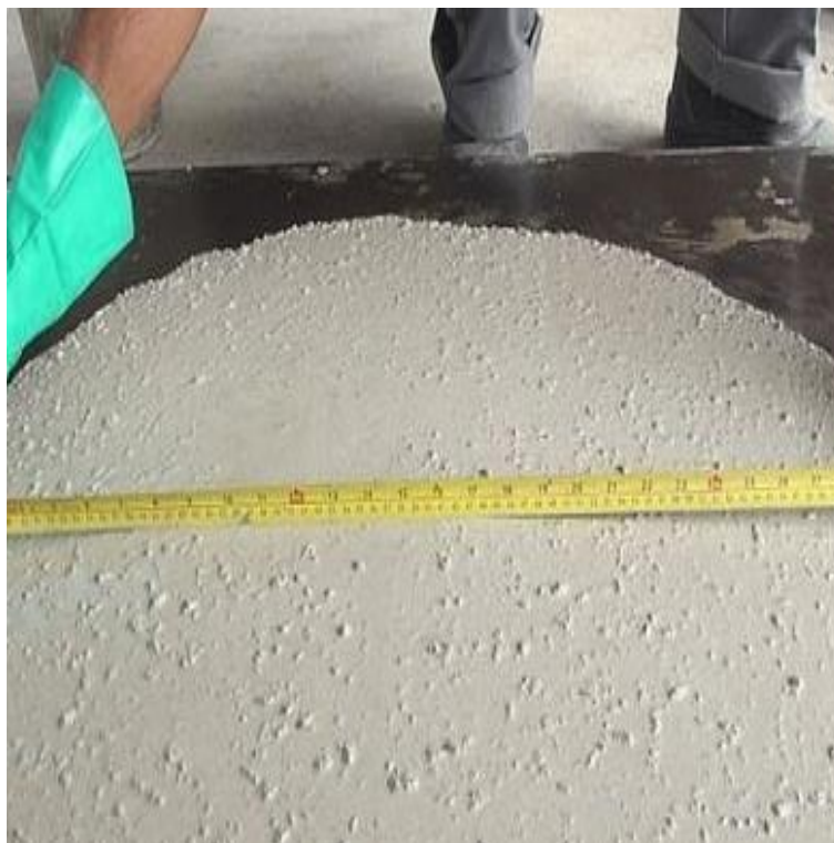
Foto: 07, Concreto Auto Adensável
