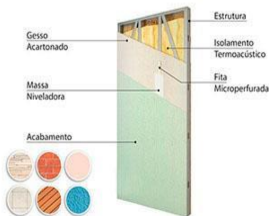
Figura 2 – Esquema de Vedação e Isolamento
