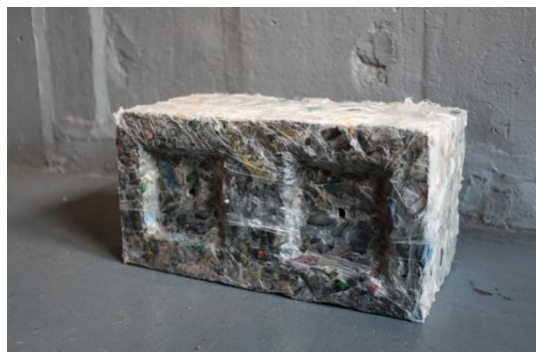
Imagem 04: Tijolo “replast”, feito a partir plástico marinho
