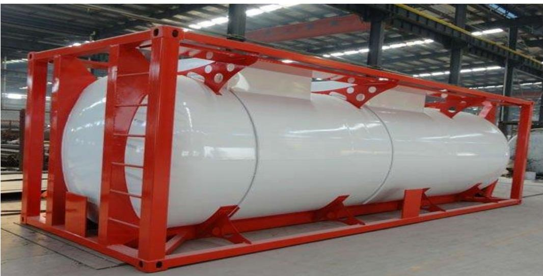
Figura 6 – Container tipo Tank.
