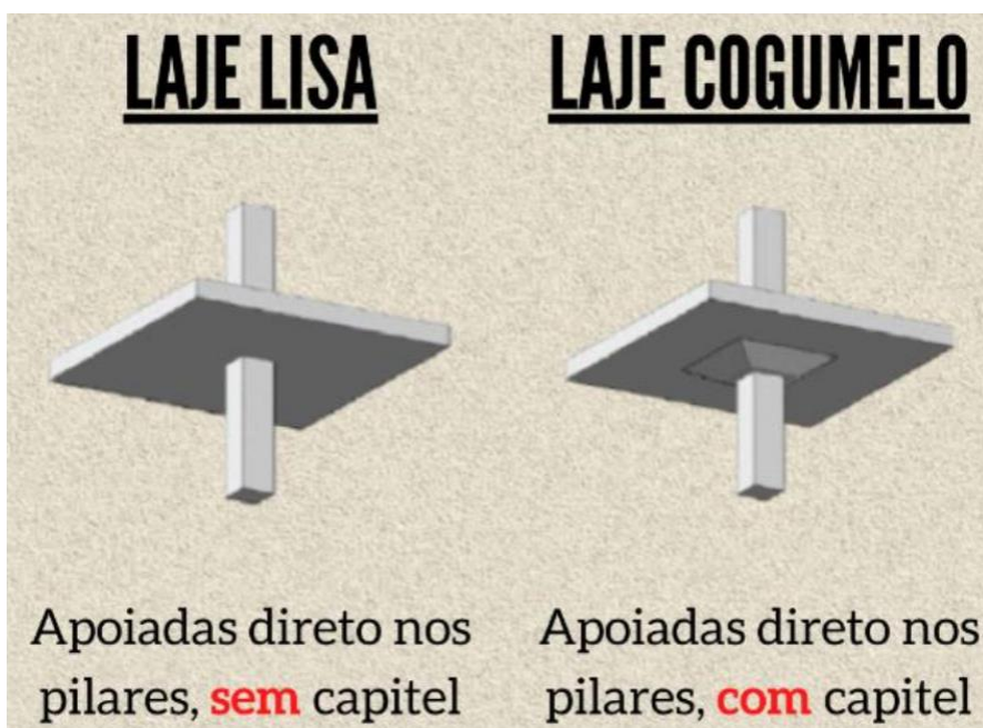
Figura 4 - Detalhamento lajes lisas e cogumelos
