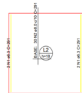
Figura 25 – Armação inferior do radier do pavimento possô elevador no eixo Y
