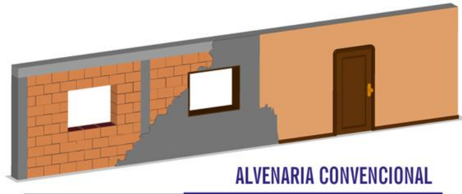
Figura 5: Parede em alvenaria convencional.
