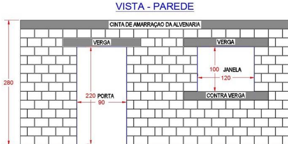
Figura 9: Demonstração de verga, contra verga e viga.
