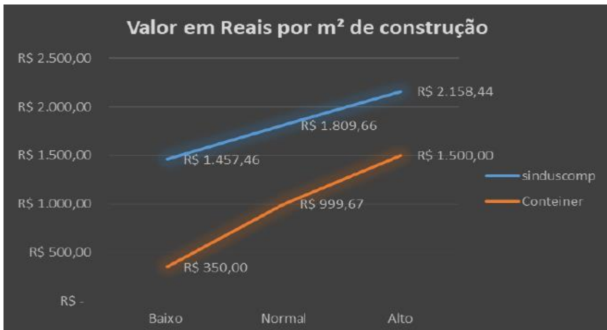
Figura 10 - Comparativo Alvenaria x Container
